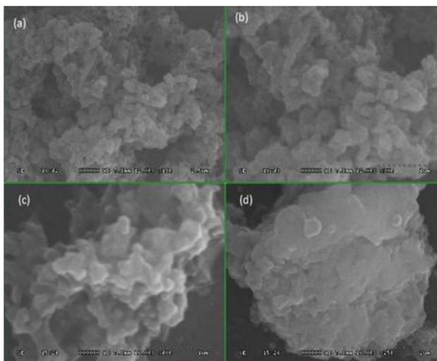
**Fig. 2:** SEM images of (a) PANI/Mn<sub>3</sub>O<sub>4</sub> (× 18 k); (b) PANI/Mn<sub>3</sub>O<sub>4</sub> (× 12.0 k); (c) PANI (× 40 k); (d) PANI (× 25 k).
