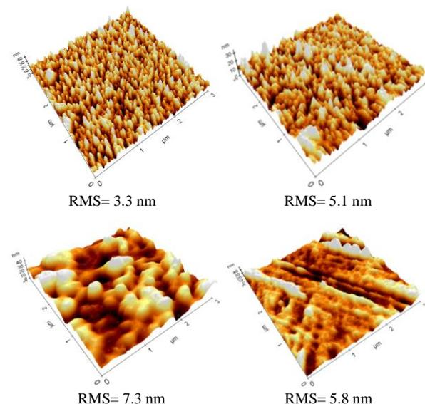
**Fig. 4.** AFM images of ZnO films (a)  $5 \times 10^{-3}$  Pa (b)  $8 \times 10^{-3}$  Pa (c)  $2 \times 10^{-2}$  Pa (d)  $5 \times 10^{-2}$  Pa.
