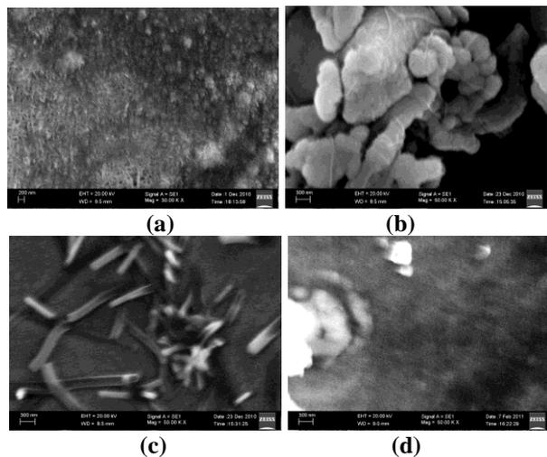
**Fig. 2.** SEM images of ZnO films (a)  $5 \times 10^{-3}$  Pa (b)  $8 \times 10^{-3}$  Pa (c)  $2 \times 10^{-2}$  Pa (d)  $5 \times 10^{-2}$  Pa.
